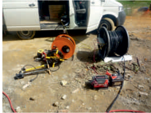
Imagen del equipo necesario para la realización de un ensayo Cross-Hole.
