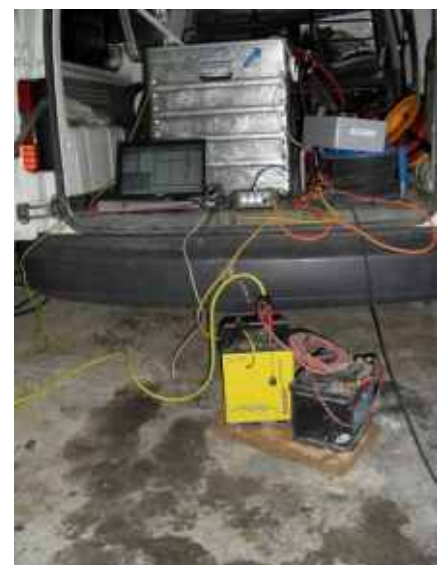
Imágenes del equipo utilizado para la toma de datos en el ensayo Cross-Hole
