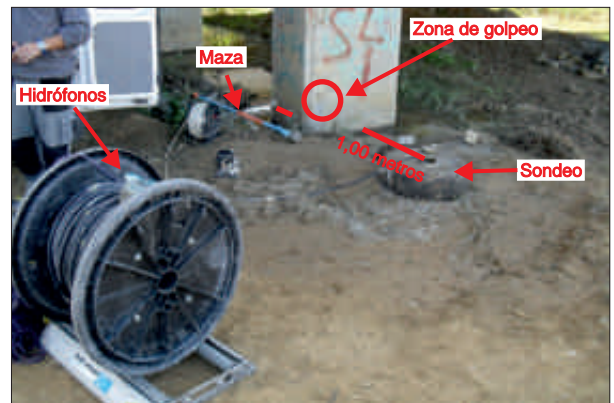
Imagen del equipo necesario para la realización de un ensayo de Sísmica Paralela.
