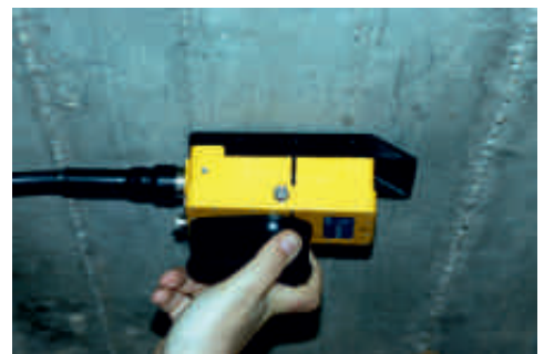
Estudio realizado con antena de Geo-radar de 2,3 GHz.
