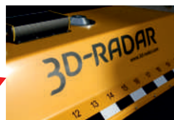
Para la adquisición de los datos se remolcó la antena de 3D-Radar con un vehículo todo terreno sobre la superficie practicable del túnel.
