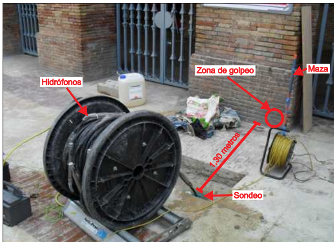
Imagen del equipo necesario para la realización de un ensayo de Sísmica Paralela.
